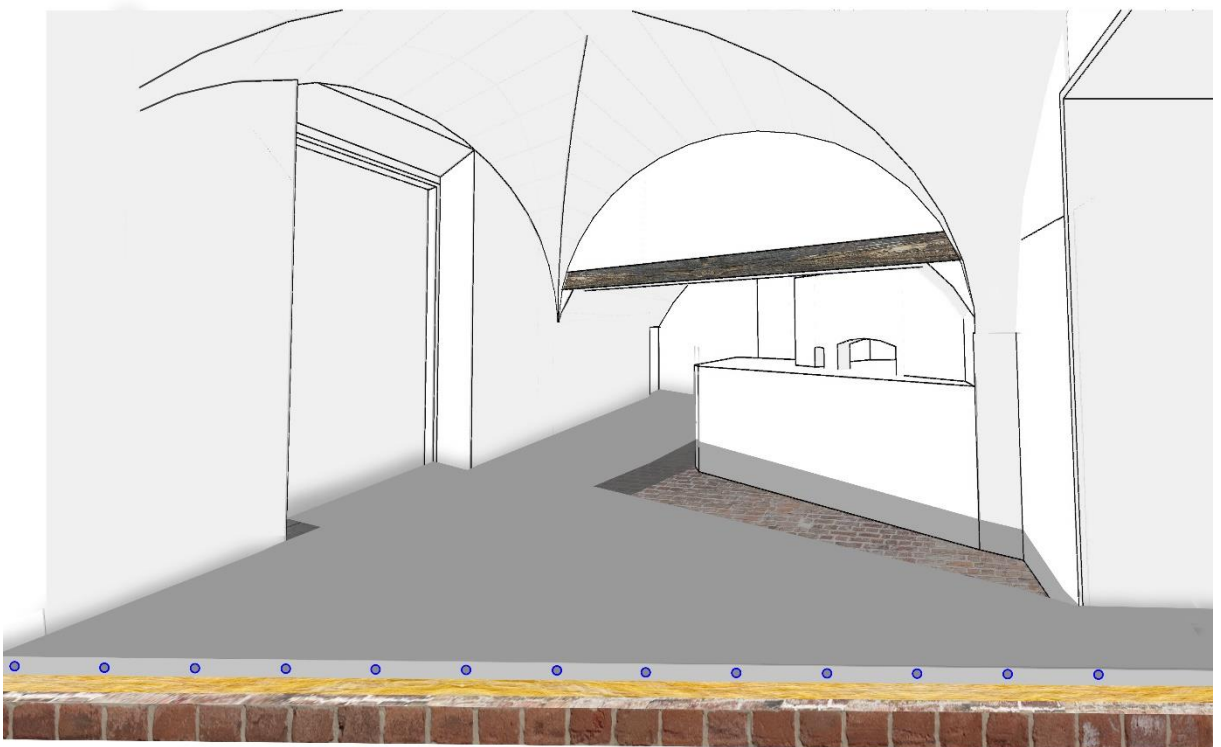
Obr. 8.42: Schematický vizuál čiernej kuchyne s aplikáciou nízko-teplotného vykurovania (reverzibilná podlaha) (Zdroj: E. Ruhigová)
