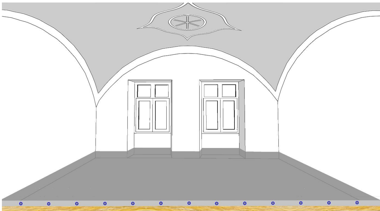
Obr. 8.35: Schematický vizuál barokovej izby s aplikáciou nízkoteplotného vykurovania (Zdroj: E. Ruhigová)
