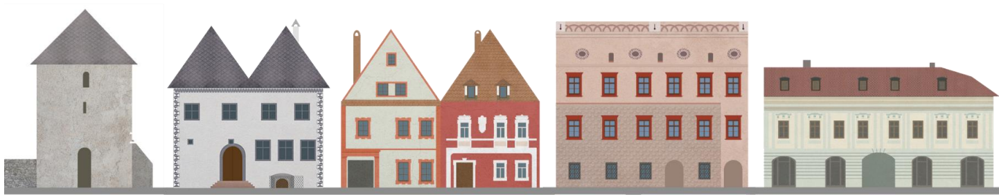
Obr. 5.3: Vývojové etapy meštianskeho domu z hľadiska prejavov vykurovania v rámci fasády. Zľava: gotický vežový dom (Križany, 1. polovica 14. storočia), gotický meštiansky dom (Kremnica, 14. storočie), gotický meštiansky dom (Bardejov, 15. storočie), renesančný dom s atikou (Banská Bystrica, Thurzov dom, 15-16. storočie), barokový meštiansky dom (Nitra, Štefániková ul., 17-18. storočie) (Zdroj: E. Ruhigová)
