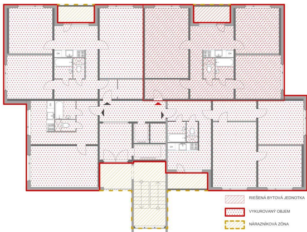
Obrázok 164 Hranice vykurovaného objemu na typickom podlaží ZTB-13B – návrh nárazníkových zón, s vyznačením riešenej bytovej jednotky (Zdroj: Ruhig, 2019)
